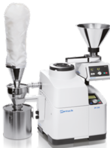
Автоматизированное измельчение больших объемов проб: Мельница ZM 200 с вибрационным питателем DR 100 и циклоном
