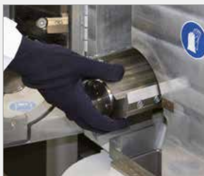
Быстросъёмный ротор для облегчения и ускорения очистки
