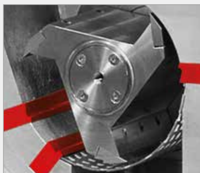
Эффективный размолом благодаря 3 режущим брускам двойного действия (SM 200 и SM 300)
