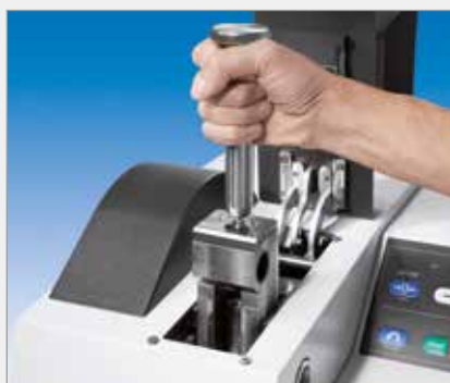
Мелющая щека легко снимается без использования инструментов
